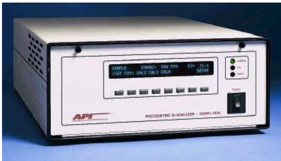
Imagen 2. Analizador automático continuo de ozono 400A marca TELEDYNE API.
