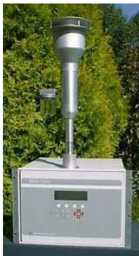
Imagen 1. Analizador automático continuo de partículas BAM - 1020 marca Met One Instruments Inc.
