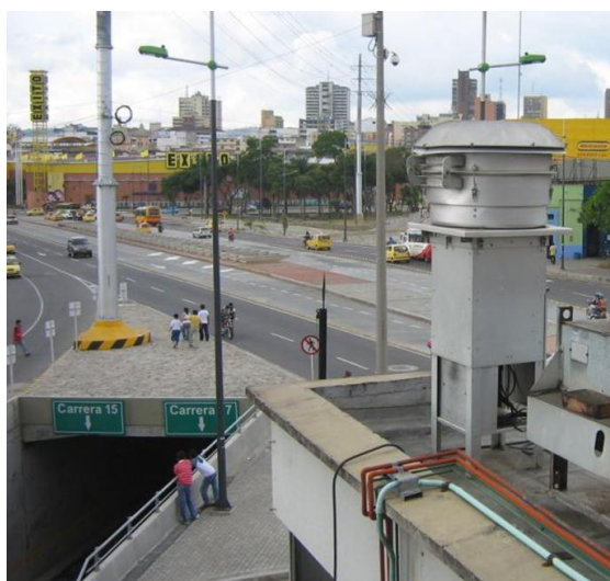
Figura 2. Muestreador de alto volumen utilizado para la recolección de muestras. Ubicación: Intersección de la Diagonal 15 con Carrera 17
