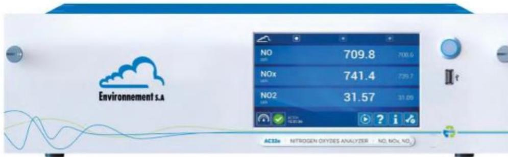
Imagen 2. Analizador de Dióxido de Nitrógeno Envea AC32e
