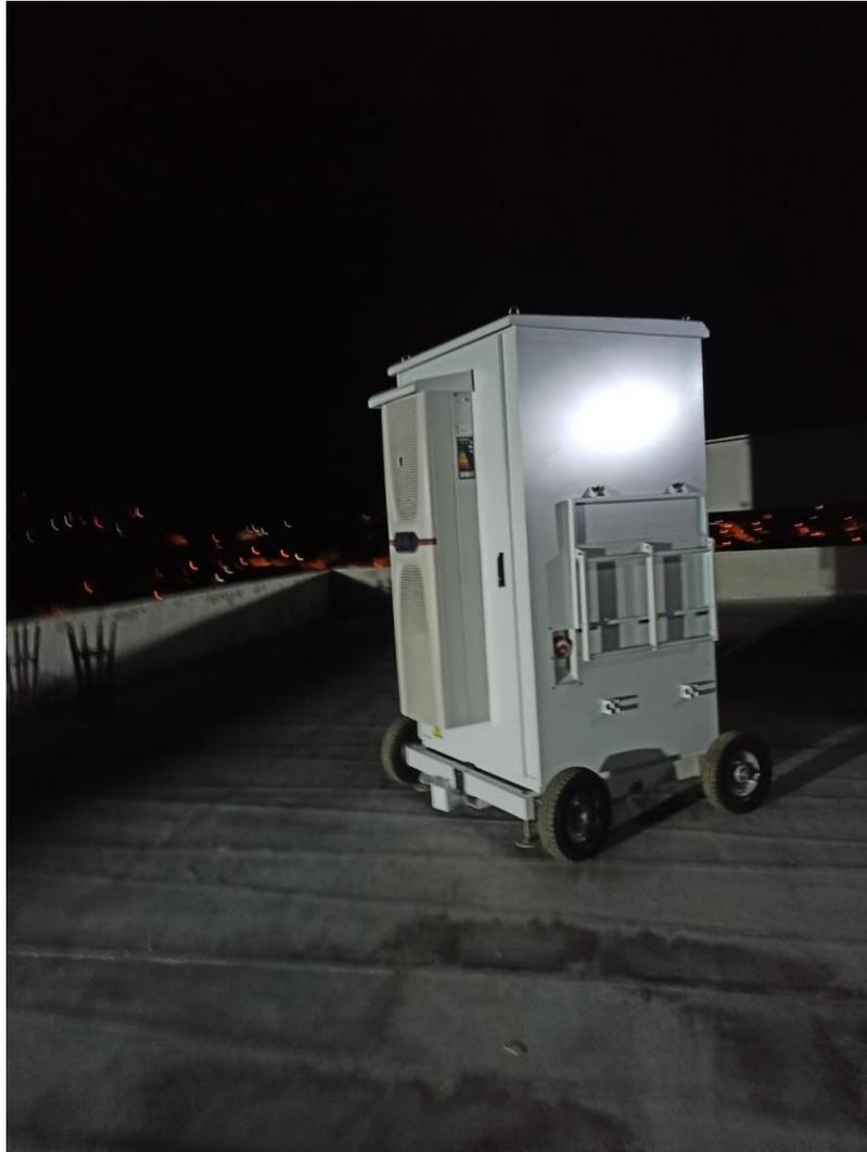
**Imagen 33. Instalación Estación de Calidad del Aire Hospital Local del Norte.**
