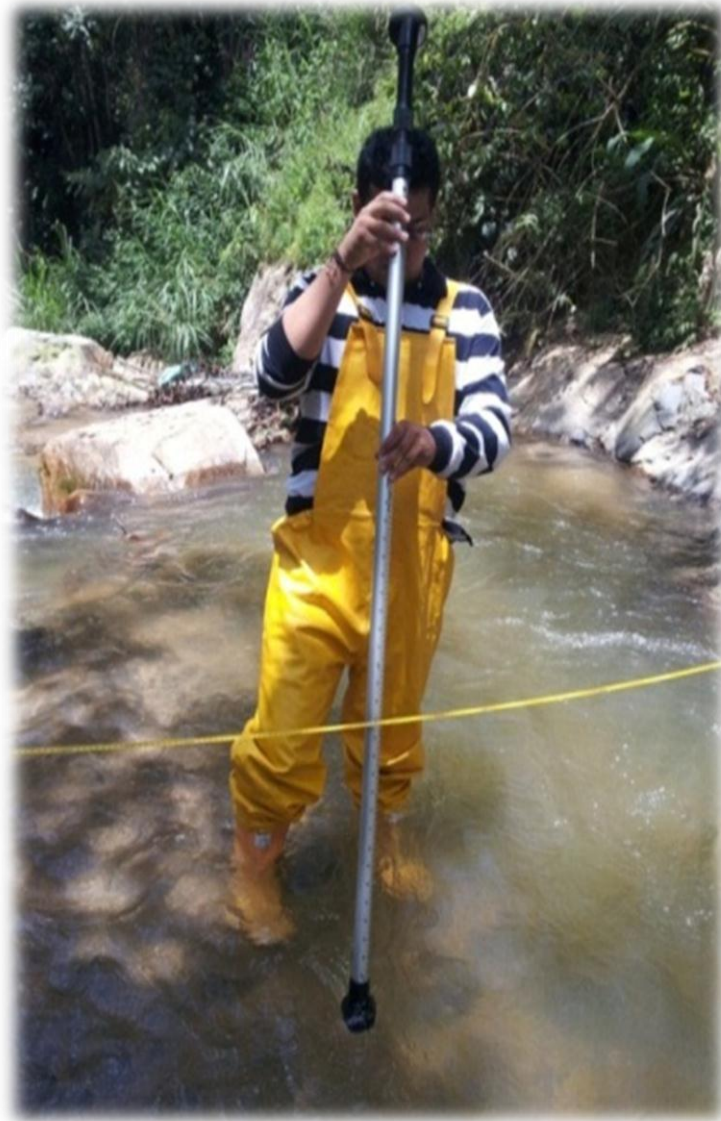
Figura N° 9. Medición de profundidad y velocidad con el Correntómetro Global Water Cuadrilla 1
