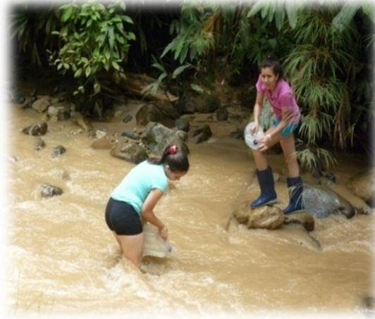
Figura N° 3. Inyección del Trazador de (NaCl) al río Frío Cuadrilla 2
