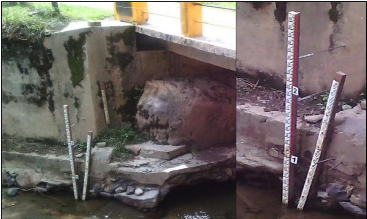
**Imagen 2. Mira limnimétrica instalada en la estación SA-07 Uña de gato.**
