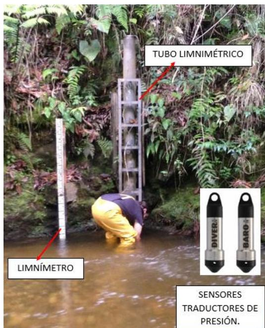
**Figura 3.** Estación automática de niveles y mira del Rasgón
