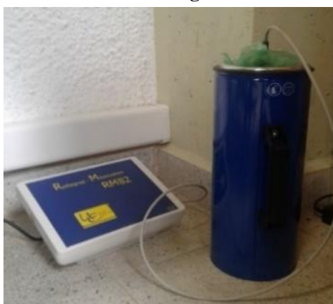
Figura 9. Dispositivo de medición del grado de madurez RM 82
